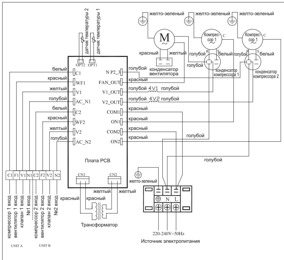
8.2 Электрические схемы внутренних блоков моделей ТСА-09GHRA/HI и ТСА-12GHRA/HI.
